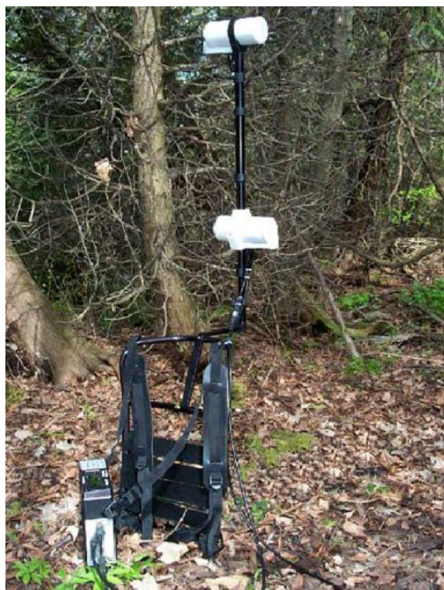
Рис. 5.11.1 Магнитометр GSM-19 в рабочем положении
